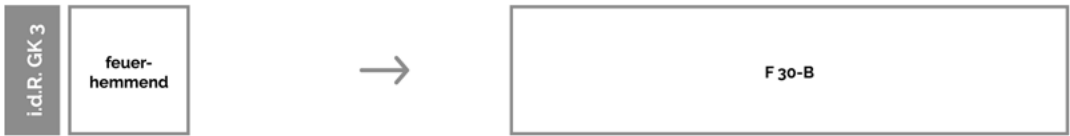
Abbildung 11 Konkretes Leistungssoll von Bauteilen in der GK 3, die feuerhemmend sein müssen
